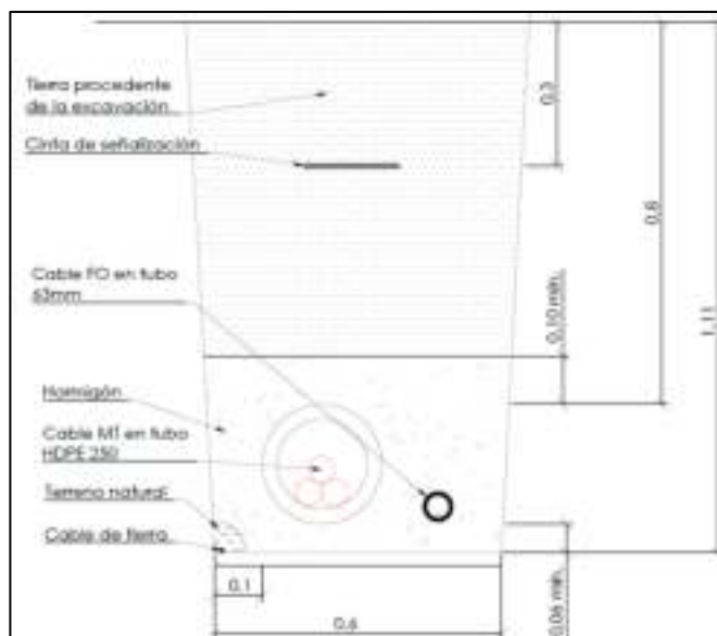
Imagen 4. Sección de zanja de cruce de caminos.
